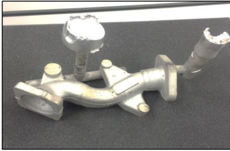
CAD・CAEを駆使した鋳造方案 と3Dプリンター造型による中空 フランジ形状AI系鋳造品の製作
